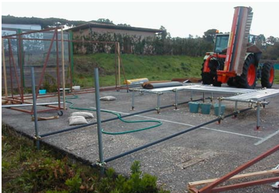
Préparation de l'emplacement pour l'essai de projection de cailloux portant sur des machines et outillages agricoles et d'entretien des routes.
