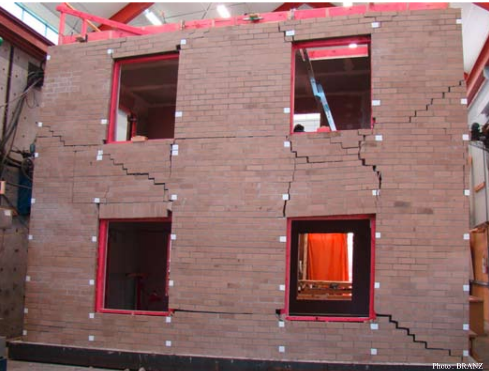
Parement en briques de deux étages après essai sur table à secousses.
