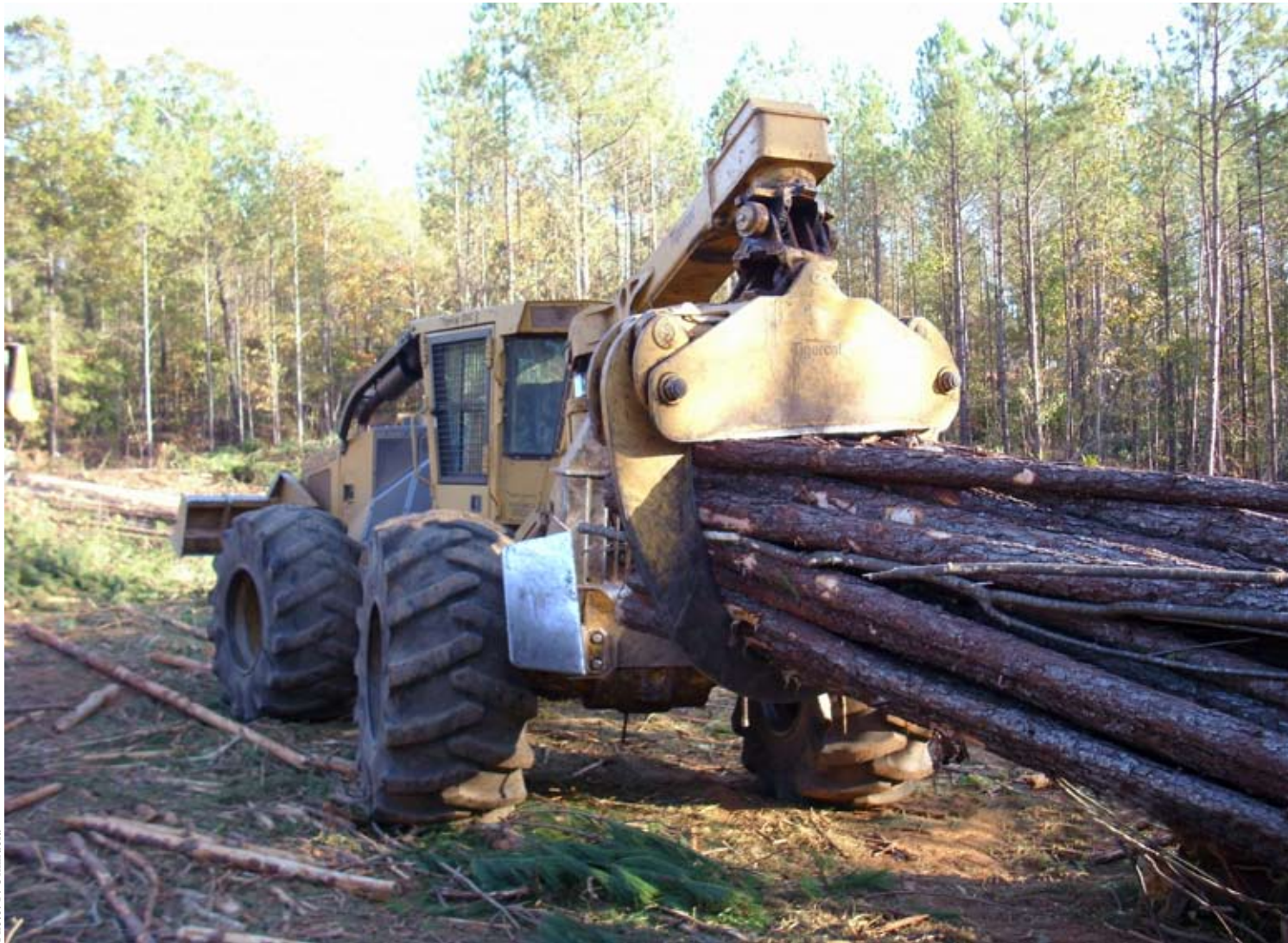
Une débusqueuse articulée à grappin déplace des billes dans une forêt américaine.
