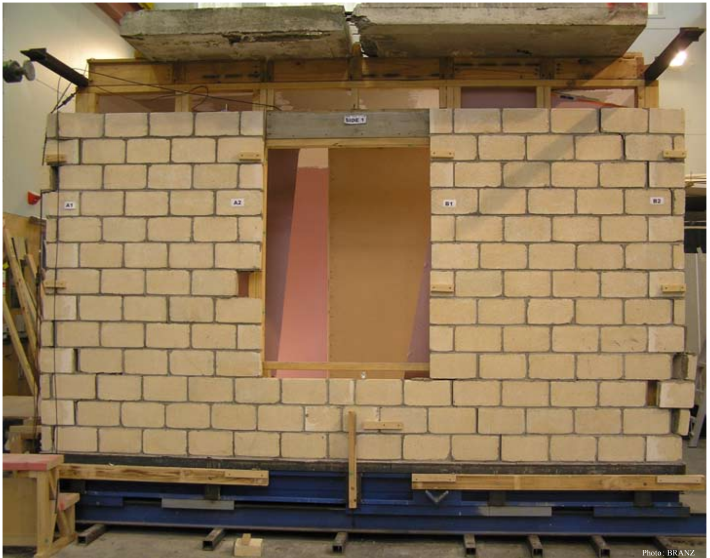
Parement en briques à l'essai sur table à secousses.
