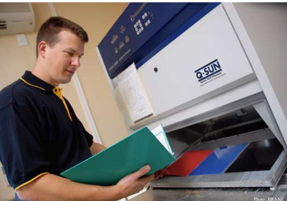
Essai accéléré de solidité aux intempéries.
