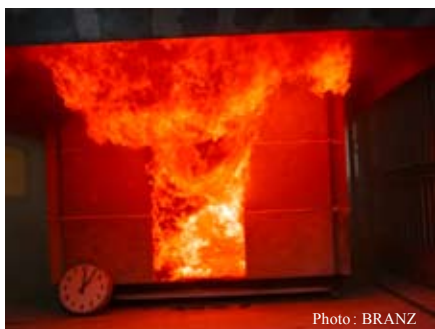
Essai de réaction au feu en chambre.
