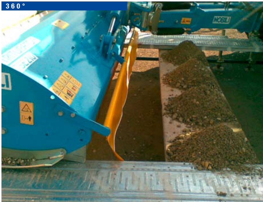
Essai de projection d'objets sur faucheuse-broyeuse à axe horizontal avec matériau d'essai composé de cailloux et de graviers.
